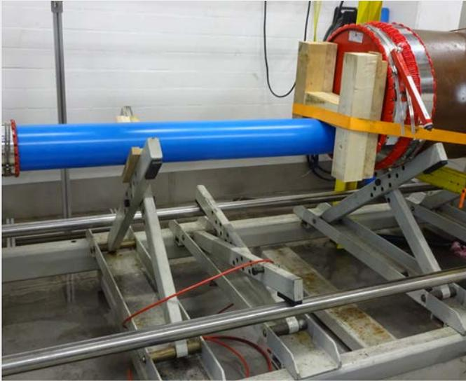
Test d'étanchéité réalisé en interne selon la norme DIN 4060 sur le banc d'essai de Funke.
