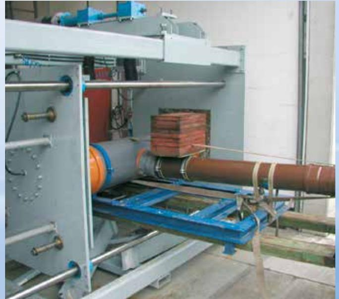
Montage de l'essai de compression
